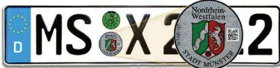
Stempelplakette mit Druckstücknummer und verdecktem Sicherheitscode
