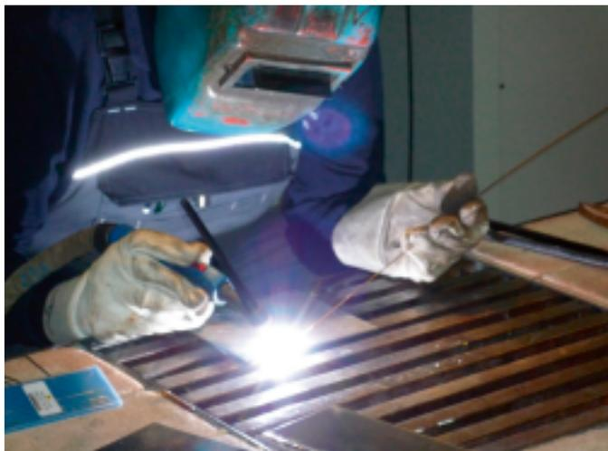
Das Wolfram-Inertgasschweißen (WIG) wird hauptsächlich dort zum Fügen von Blechen und Rohren eingesetzt, wo Schweißnahtqualität wichtiger ist als Schweißgeschwindigkeit. Nahezu jeder schmelzschweißgeeignete Werkstoff lässt sich mit diesem Verfahren verschweißen. Fast spritzerfrei und mit hoher Nahtqualität, insbesondere in Wurzellagen und Zwangssituationen. Ein Vorteil: Der Zusatzwerkstoff wird nach Bedarf zugeführt und entkoppelt die Zusatzwerkstoffmenge von der Schweißstrommenge.
